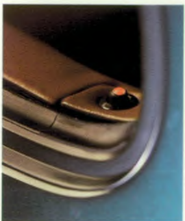
Blinkdioden in den Sicherungsknöpfen signalisieren die Alarmfunktion
