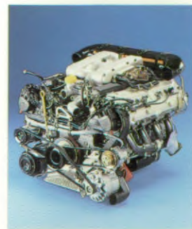
Der V8-Leichtmetallmotor des 928 GT leistet 243 kW
