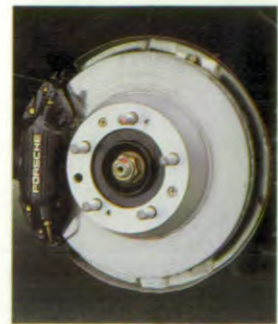
Innenbelüftete Scheibenbremsen selbstverständlich auch hinten
