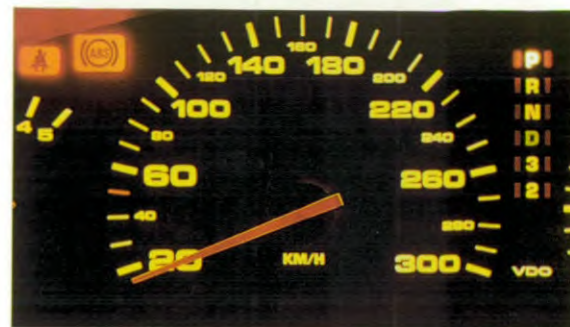
Die Instrumente im Porsche 928 – hier der Tachometer – sind Dank der kontraststarken Durchlichttechnik von vorbildlicher Übersichtlichkeit
