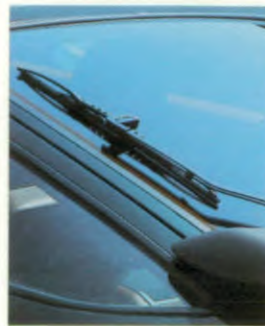
Freie Sicht nach hinten: Heckscheibenwischer und beheizbare Scheibe
