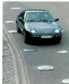
Rütteltest für Karosserie und Fahrwerk auf der „Fladenstrecke“
