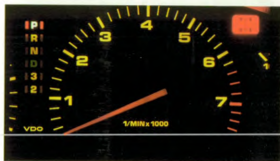
Links vom großzügig gestalteten Drehzahlmesser die Positionsanzeige des 4-Gang-Automatikgetriebes, das seine Informationen stets klar ablesbar gibt
