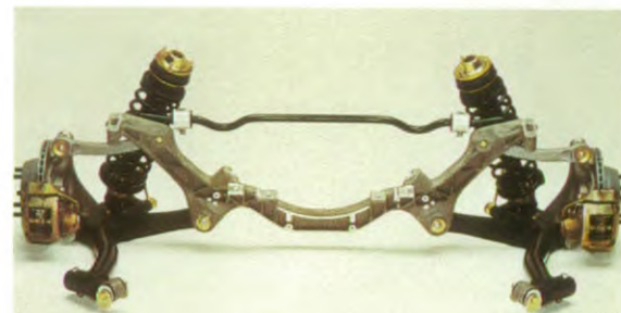
Die »Weissach-Achse« hinten, bietet ein zusätzliches Maß an Sicherheit durch Kompensation von auftretenden Vorspuränderungen
