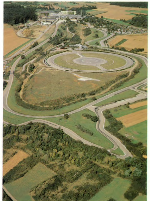
Fahrwerksabstimmung und Funktionstests einschließlich Fahrzeugdauerläufen im Zeitraffer auf der Prüfstraße des Porsche Entwicklungszentrums Weissach
