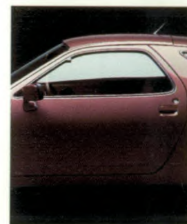
Motorhaube und Türen stabil und gewichtsparend aus Aluminium
