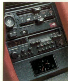
Die vollautomatische Klima-, Heizungs- und Lüftungsanlage
