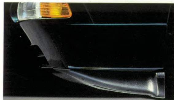
Die verformbaren Front- und Heckteile des Porsche 928 stecken kleinere Stöße bei Geschwindigkeiten bis 5 km/h schadlos weg
