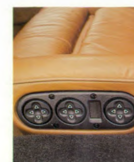
Die Sitzverstellung in alle Richtungen erfolgt elektrisch
